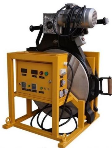
**Торцеватель в боксе со встроенным электрошкафом**
