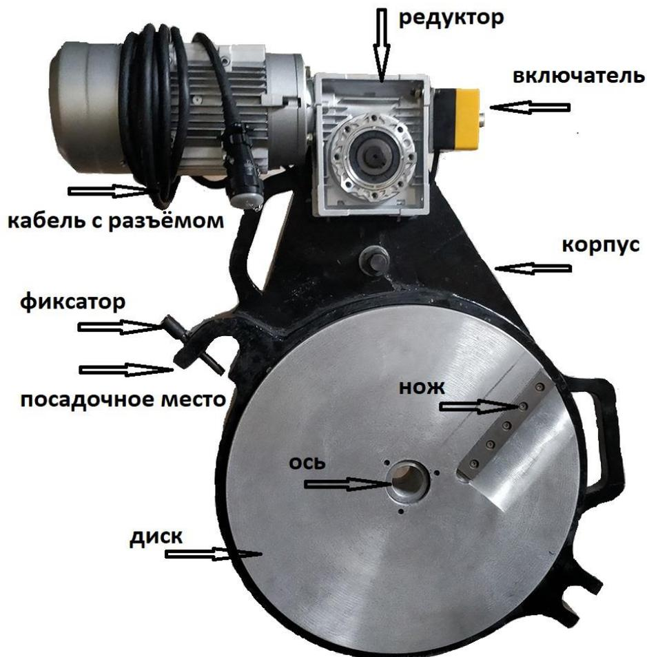
Торцеватель предназначен для выравнивания торцов труб перед сварочным процессом. Устанавливается на штанги центратора между двух зажатых в хомутах труб. Включается. Трубы плавно сводятся, прижимаются к торцевателю с двух сторон. Ножи, установленные на вращающихся дисках, снимают стружку. После выхода непрерывной стружки длиной в 2-3 оборота, торцевание можно завершить.
