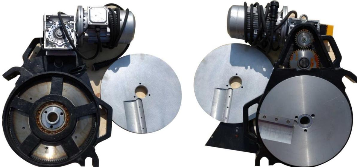
Устройство и принцип действия торцевателя.
