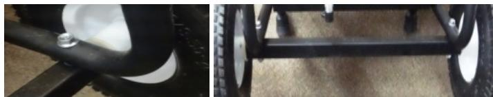
2. Установите ось на 2 болта с гайками.
